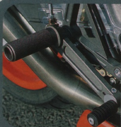
Exzentriker: filigran gefräste, einstellbare Fußrastenanlage
