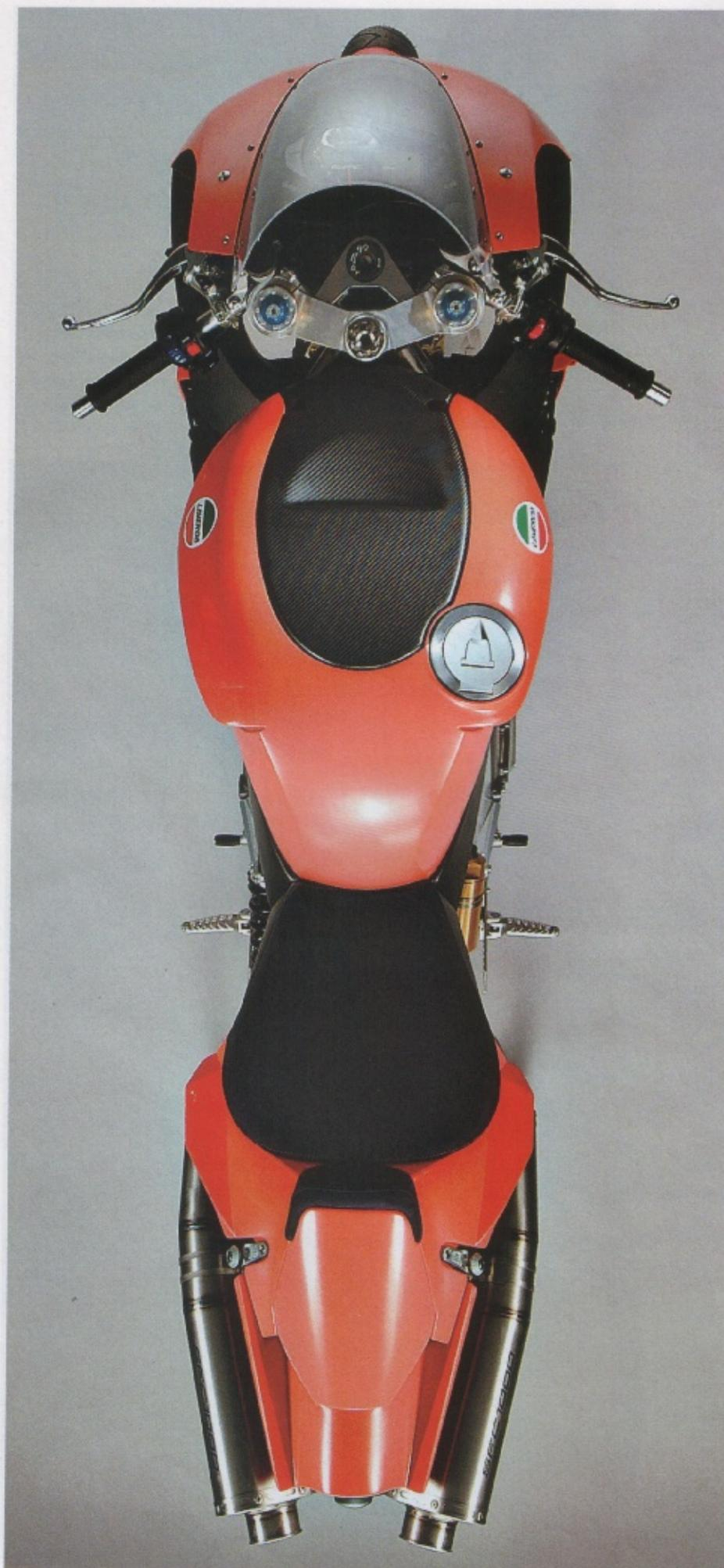
Von oben sieht die neue SFC sehr aerodynamisch aus. Das Fahrwerk lässt sich an allen entscheidenden Stellen individuell einstellen. Mit markant asymmetrischen Stützen umschließt der Tank die Ansaugbox
