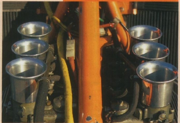
Die Trompeten von Jericho: Auch der darüber liegende Tank kann das glorreiche Ansaugröcheln der sechs Fallstromvergaser kaum dämpfen
