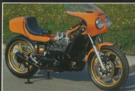
Der erste Versuch: kurze Schwinge, Zentralfederbein unter dem Getriebe liegend. So stand der in der Firmenfarbe Orange lackierte Renner erstmals 1977 auf der Mailänder Messe
