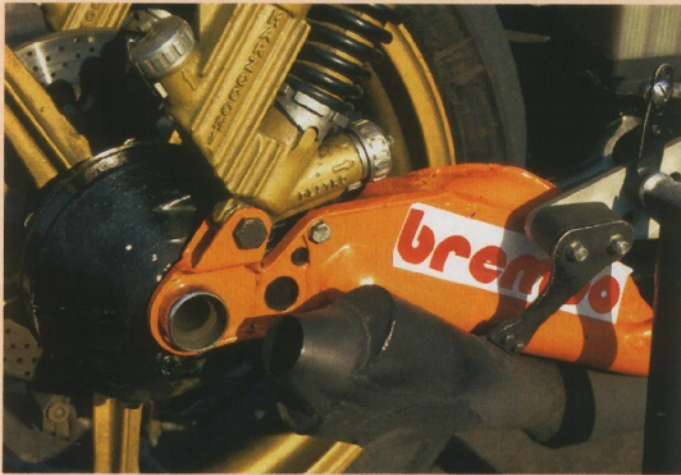
Aufwendige Marzocchi-Gasdruckdämpfer halten das Heck im Zaum. Der „zurechtgebratene“ Auspuff zeugt vom Bemühen um Schalldämpfung
