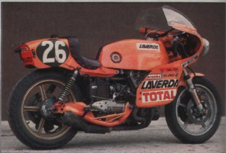
Steife und extrem lange Schwinge, im Motorblock gelagert
