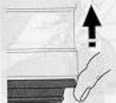
Sequenza di montaggio raschiapolvere Dust seal assembly sequence
