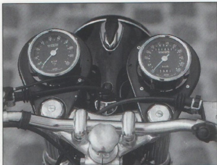
SMITH Drehzahlmesser 69 000 300 Tacho 400
