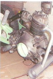
▲ Le moteur de 60 cm 3 est monté au même endroit que le 49 cm 3 . Réservoir basculé, on le reconnaît à sa culasse différente.
