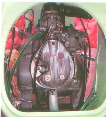
▲ Le moteur de 60 cm 3 est monté au même endroit que le 49 cm 3 . Réservoir basculé, on le reconnaît à sa culasse différente.
