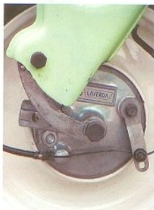
◀ Le freinage est assuré par des tambours simple-came montés sur des roues de la moto de neuf pouces. La suspension avant est confiée à une fourche à biellettes (photo S. Forster).
