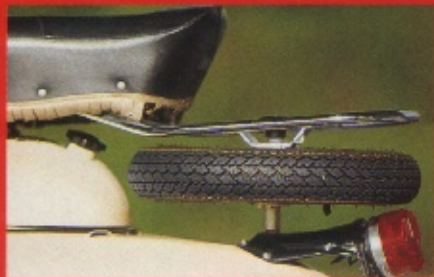
Verbesserungen am 60-Kubik-Modell: Das Ersatzrad hinter dem Tank ist mit einer Bakelit-Rändelmutter leicht abzuschrauben, die vordere Bremsankerplatte neu
