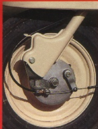
Verbesserungen am 60-Kubik-Modell: Das Ersatzrad hinter dem Tank ist mit einer Bakelit-Rändelmutter leicht abzuschrauben, die vordere Bremsankerplatte neu
