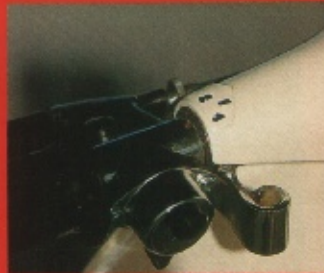
Besonders spritzig ist der 1,3-PS-Viertakter nicht. Seine zwei Gänge reichen so eben für 40 km/h Höchstgeschwindigkeit
