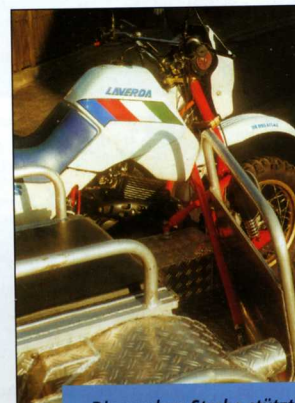
Die vordere Strebe stützt sich auf der rechten Seite des Beiwagenrahmens ab.
