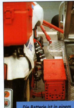
Die Batterie ist in einem eigenen Kasten zwischen Motorrad und Beiwagen untergebracht.
