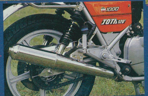
Der Hinterrad-Scheibenstopper wollte bei Regen erst gründlich trockengebremst werden.
