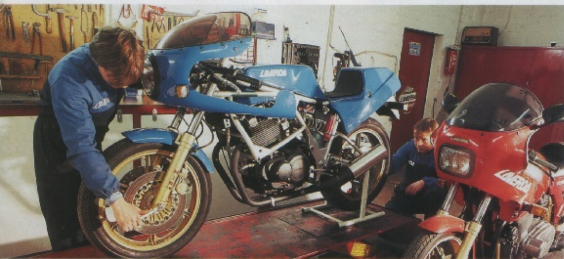
Bei Importeur Moto Witt in Köln entstanden auch eigene Laverda-Kreationen, wie diese supersportliche 600er-Version mit Stahlrohr-Brückenrahmen
