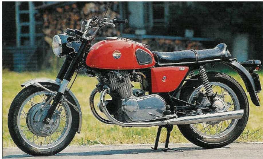
Im Jahr 1968 entschlossen sich die Laverda-Techniker den Hubraum von 650 ccm auf 750 ccm aufzustocken. Da die Verdichtung zurückgenommen wurde, stieg die Leistung jedoch nur um zwei PS.
