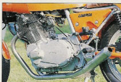
Das SFC-Triebwerk erhielt größere Ventile und höher verdichtende Kolben.
