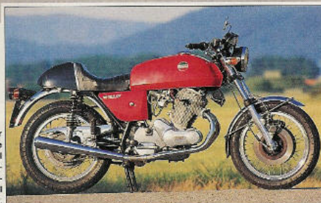
Optische Retusche: Der SF-2-Tank verlor seine Kniekissen, die Gabel kam nun ohne Faltenbälge aus, und die Sitzbank zierte ein Heckteil aus Kunststoff.
