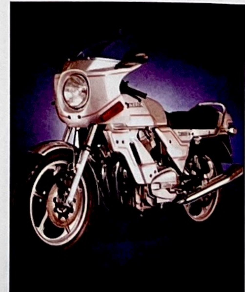
1979 Laverda 1200 TS: um je fünf Millimeter aufgebohrte 1000er, komplett mit Cockpit-verkleidung und Tieferlegung
