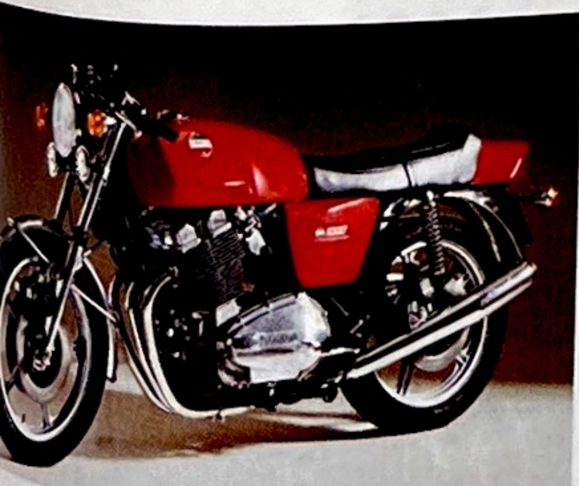
1976 Laverda 1000-Dreizylinder, mit Aluminiumgussrädern und Scheibenbremse auch hinten
