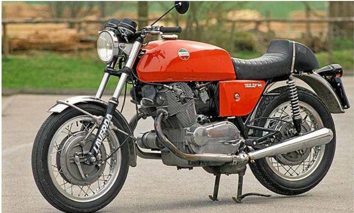
Trommelbremsen, japanische Instrumente, Höckersitzbank: die 750 SF1 von 1973.
