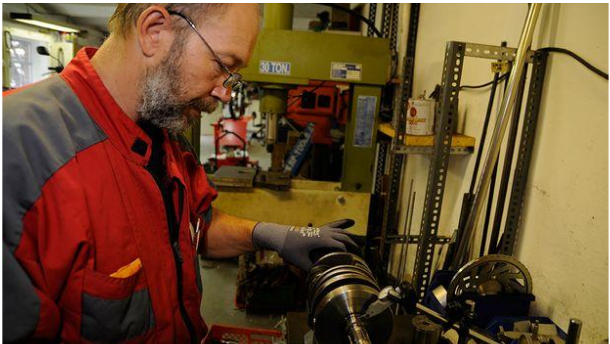
Roger Viehl kontrolliert den Rundlauf einer Dreizylinder-Kurbelwelle. ein Blick auf seinen einschlägig zugeparkten Hof verrät: Er macht das nicht zum letzten Mal.
