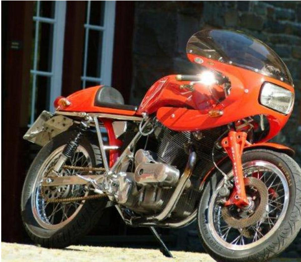
Der Schweizer Präzisionsfanatiker Fritz Egli entwickelte in den späten 1960er Jahren auf Basis einer schüchteren Vincent Black Shadow sein Prinzip des Einrohr-Rahmens aus vernickeltem Präzisionsstahl, weil er es leid war, mit zwar relativ kräftigen Renntriebwerken aber auf unhaltbaren Fahrwerken die berüchtigten Bergrennen auszureiten.
