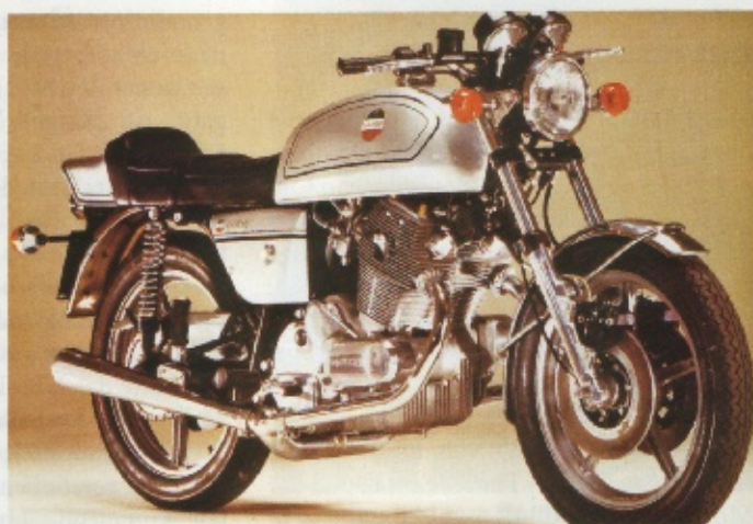
1974 führte die SF2 als jüngster Spross die SF-Baureihe weiter. Auffälligste Neuerung: Die massive Brembo-Doppelscheibenbremse
