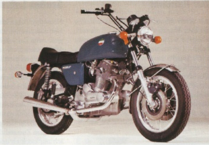
1974 führte die SF2 als jüngster Spross die SF-Baureihe weiter. Auffälligste Neuerung: Die massive Brembo-Doppelscheibenbremse
