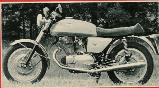
Bild oben: Der E-Starter liegt hinter den Zylindern, die Lichtmaschine mit Keilriemenantrieb vor dem Kurbelgehäuse.
