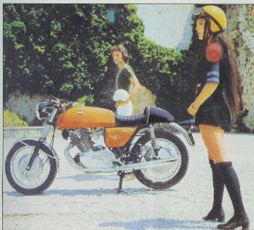
750 SF, Modell 1972, mit geänderten Tank und Nippon Denso-Instrumenten
