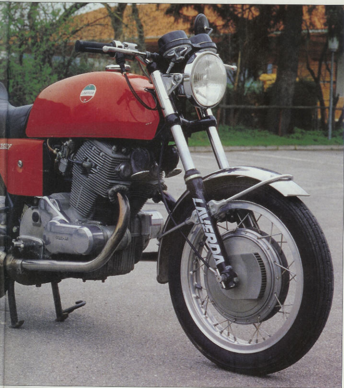
Bei der 750 SF1 rückte das Interferenzrohr der Auspuffanlage unter das Getriebe und setzte in Kurven schnell auf
