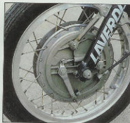
Das 1973er Modell 750 SF1 wartete mit gestängebetätigten Duplexbremsen und neuen Schalldämpfern auf. Die Anzeige-Instrumente kamen aus Japan
