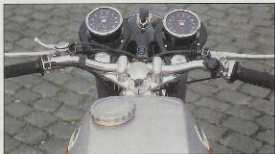
750 S, Modell 1971, mit neuen Bremsen, Interferenzrohr vorn und Smiths-Instrumenten
