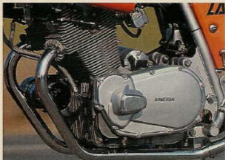
Der 744-cm<sup>3</sup>-Gleichläufer erzeugt auch bei hohen Drehzahlen erstaunlich geringe Vibrationen
