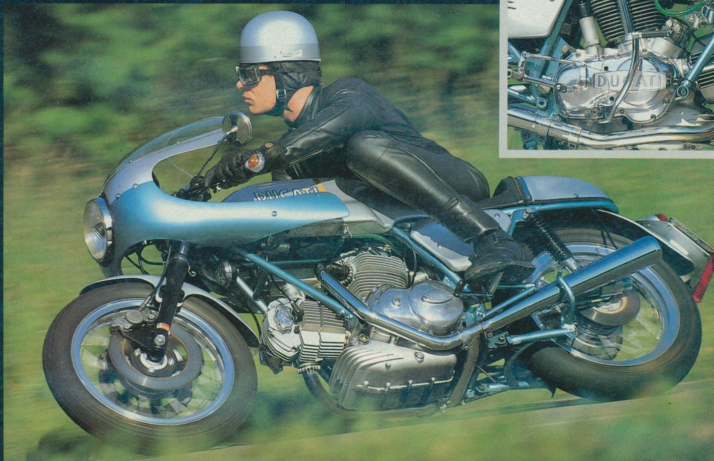
tung wie bei der Laverda 750 SFC rechts, der erste Gang oben. Der nutzbare Drehzahlbereich findet sich ganz woanders als bei der 748. Ab etwa 3000/min liefert das Königswellen-Triebwerk verwertbare Power, bei 5000/min schiebt der Twin mit Macht, und bei wenig mehr als 8500/min (wo die Maximalleistung anliegt) ist Hochschalten angesagt. Etwa dort wird der Hightech-V2 der 748 erst richtig munter und
