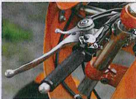
Der Choke-Hebel macht den Umgang mit dem Straßenrenner einfacher. Bei den Amal-Vergasern der ersten Serie fehlte er noch
