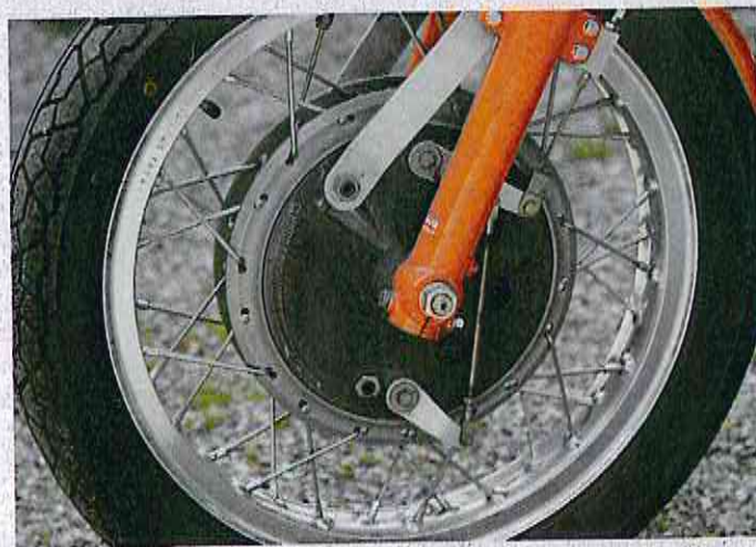
Obwohl die Laverda-Trommel der SF und SFC den Namen gab (das „F“ steht für freni, Bremse), bot das Werk auch die beliebte Ceriani-Trommel an
