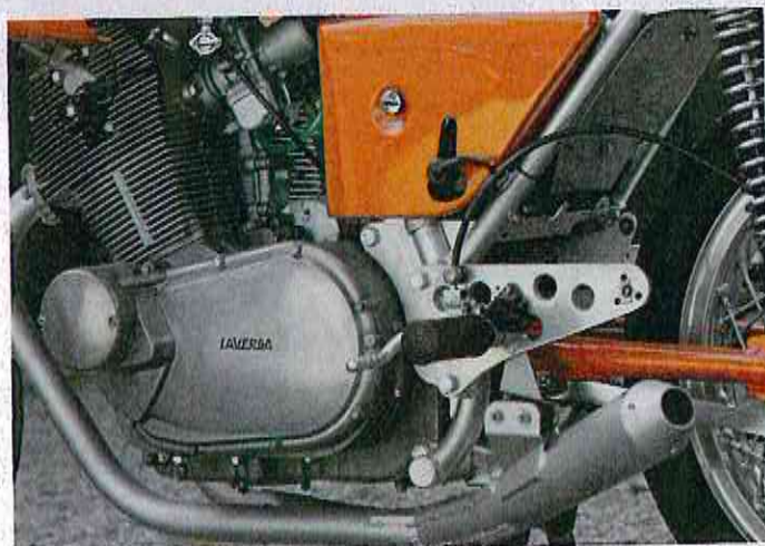
Nichts für Fahrer mit Gelenkproblemen: Die Fußrasten sitzen sehr hoch und weit hinten. Ein Fall für Spezialisten: Bremse links, geschaltet wird rechts
