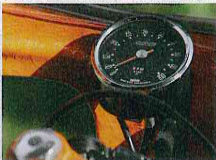
Keine nationalen Scheuklappen: Laverda kaufte Elektrik-Bauteile in Deutschland und holte sich den Drehzahlmesser von Smiths aus England
