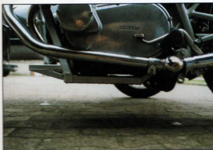
Der Hilfsrahmen schließt den Brückenrahmen der Laverda.
