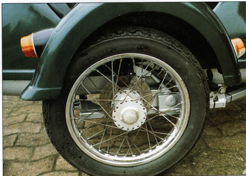
Die Brems Scheibe stammt von einem Kreidler-Moped, die Bremszange von Brembo.
