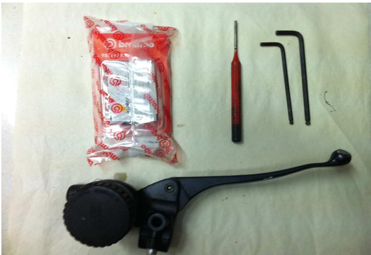
Das Reservoir wird nur durch 2 Schrauben und die kleine Platte gehalten. Wenn diese entfernt sind kann man das Reservoir drehen und vorsichtig aus dem Gehäuse nehmen. Nun ist es an der Zeit, den Hebel abzubauen in dem man zunächst die 10mm Mutter entfernt an der Unterseite und dan die Impus-Schraube komplett herausdreht. Nicht die kleine Feder-Scheibe verlieren, die im Hebel sitzt! Alles gründlich reinigen und zur Seite legen.
