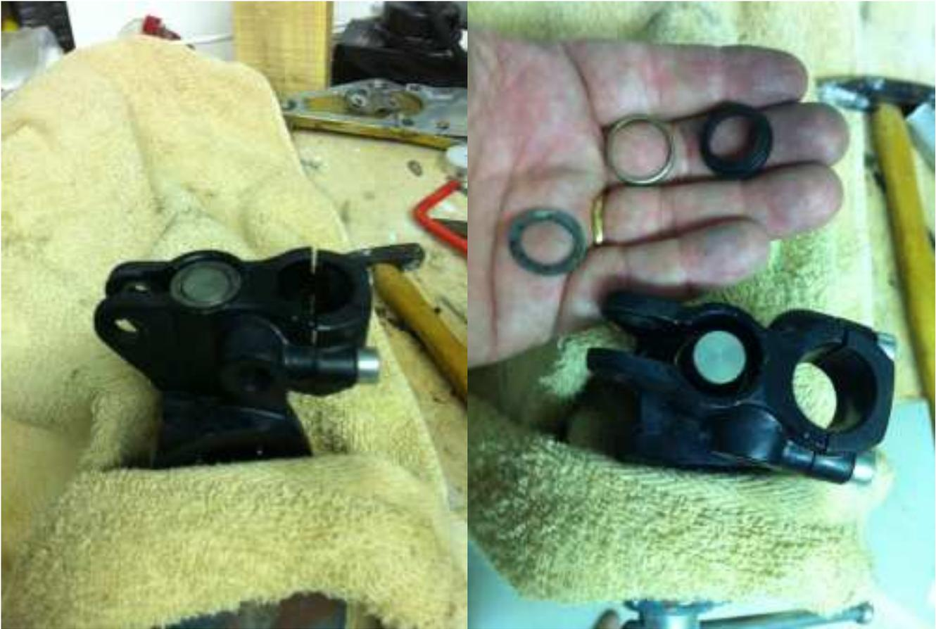
Kolben sollte selbständig nun im Zylinder bleiben. Zeit den Hebel zu montieren, den Du gut geschmiert haben solltest. Vergiss nicht die Federscheibe, die in einer Seite des Hebels sitzt!!
