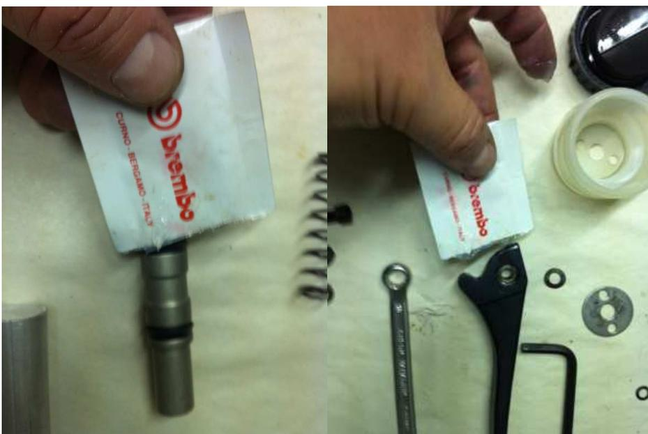
Nachdem Du die Feder so auf den Kolben gesteckt hast, das sie fest drauf bleibt stecke die Plastik-Kappe auf die Feder. So kannst Du alles recht einfach von unten nach oben in den Zylinder einsetzen und ihn dann umdrehen.
