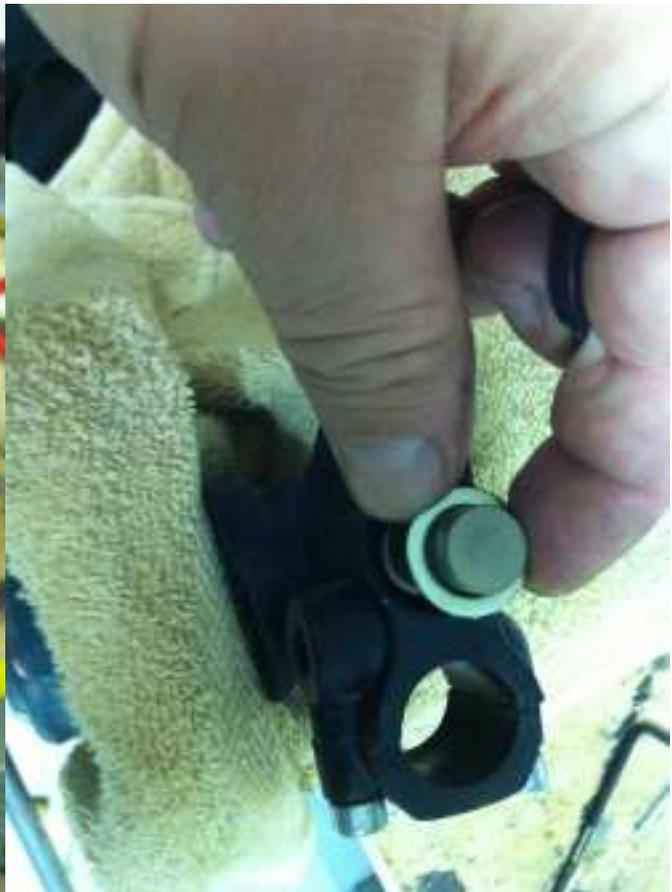
Achte auf die richtige Richtung der Teile!! Linke Seite auf den Bildern ist UNTEN. Zunächst steck den Messing-Ring mit der SCHMALEN Seite über die Gummi-Dichtung. Zumindest war das so bei allen meinen Zylindern...
