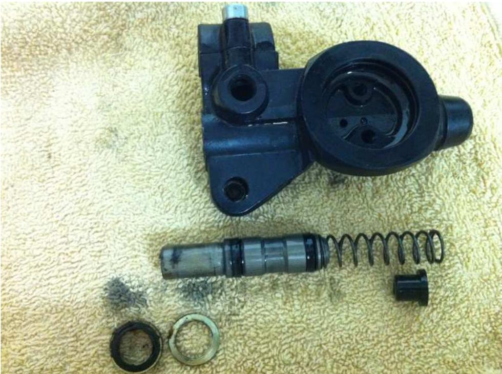
Als nächstes bereitest Du den neuen Kolben vor, der wie unten aufgeführt aussehen sollte. Behalte vom alten die Unterlagsscheibe, Gummit-Dichtung und den Sitzring; sonst musst Du Dir ein Werkzeug anfertigen zum eintreiben:
