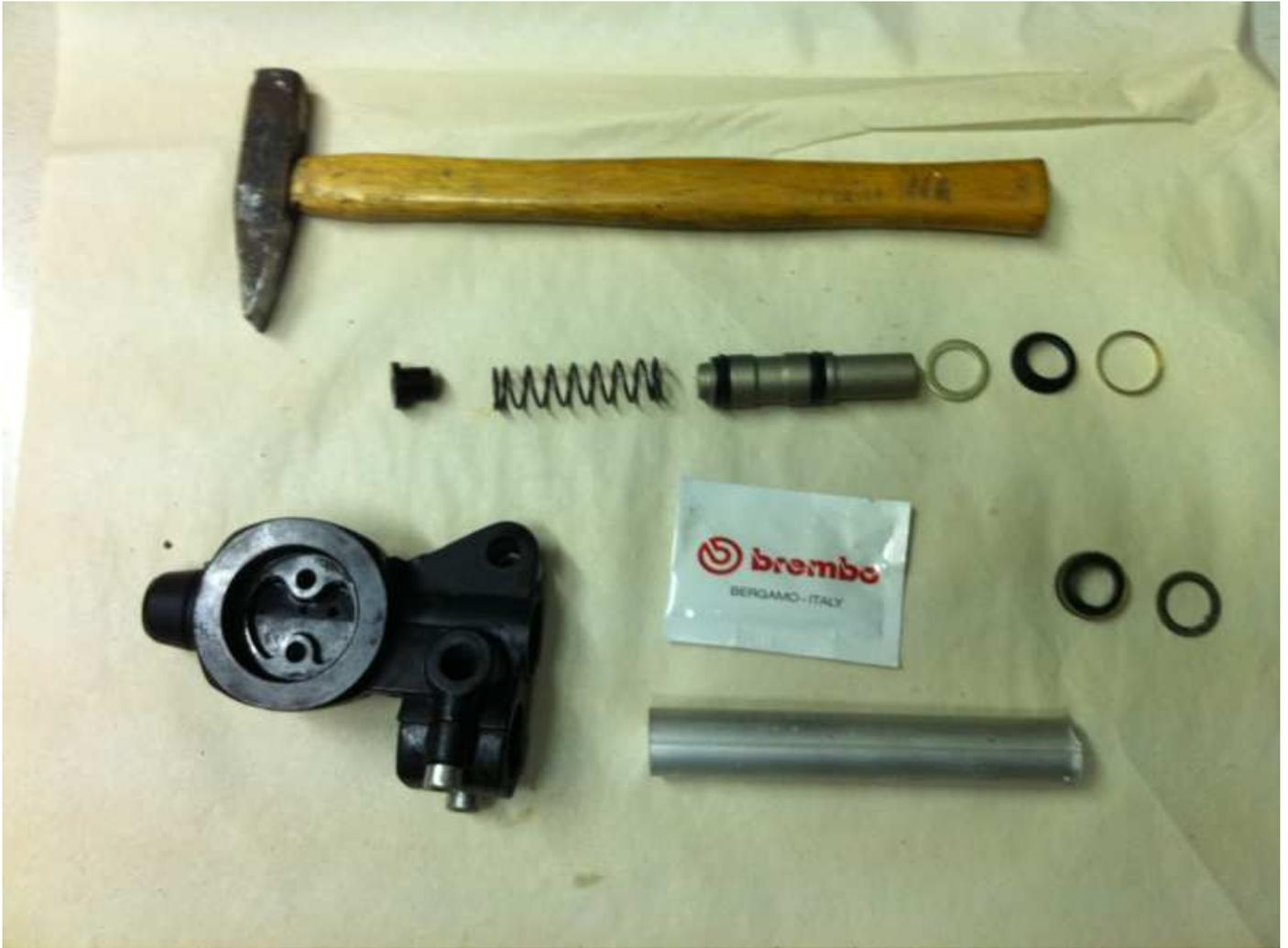
Jetzt schmiere die Dichtlippen und Verdickungen am Kolben mit dem mitgelieferten Fett. Nimm etwas für den Hebel (unter der Federscheibe und an den Auflage-Stellen):
