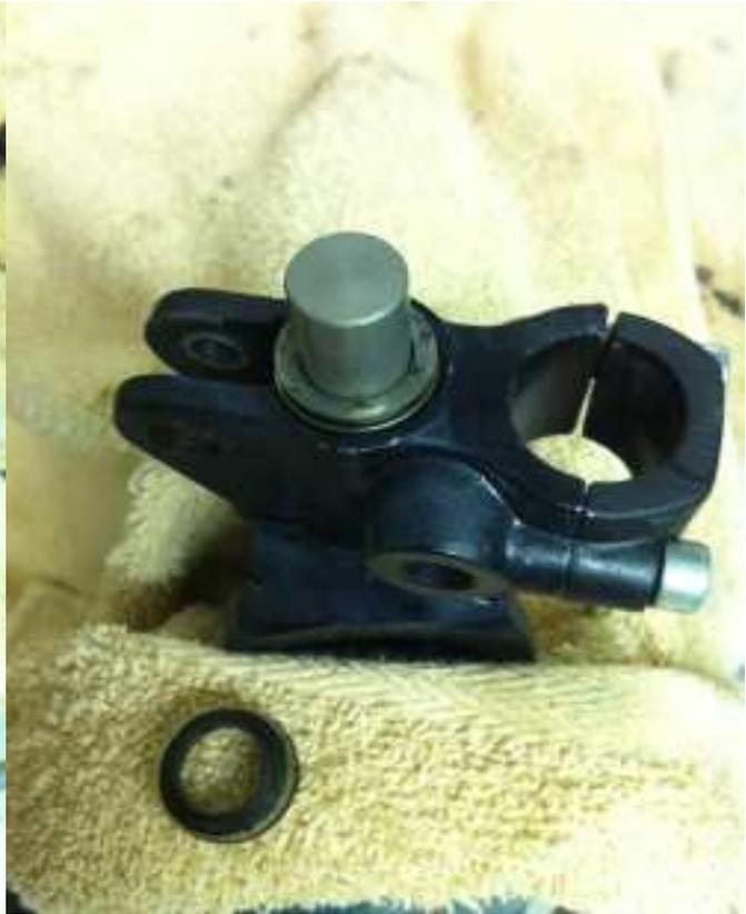
Nachdem Du alles aufgesteckt hast, drückst Du das Paket mit einem Stück Rundmaterial runter und gibst ihm ein bis zwei Schläge mit dem Hammer.
