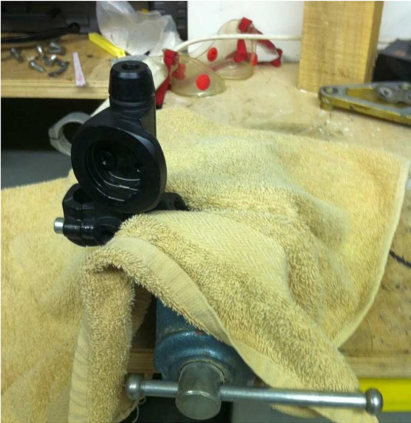
Jetzt kommt der Durchschlag zum Einsatz. Klopfe VORSICHTIG den Kolben heraus und pass auf die FüÙe auf – er hat eine Feder die den Kolben recht zügig rausdrückt. Auf der nächsten Seite ein kleiner Tipp zum Schutz Deiner Zehen...
