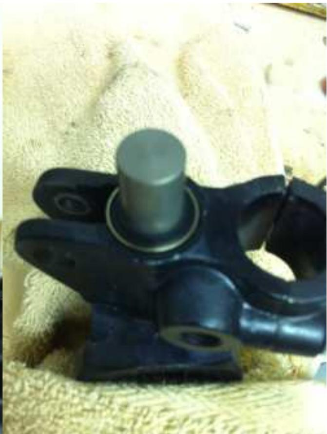
Jetzt gibt es 2 Möglichkeiten: entweder findest oder machst Du Dir ein Rohr mit AD=19 – 20mm, ID 13- 14mm oder (wie ich es hier mache) Du verwendest die alten Dichtungen zum eintreiben der neuen mit einem Stück Rundmaterial:
