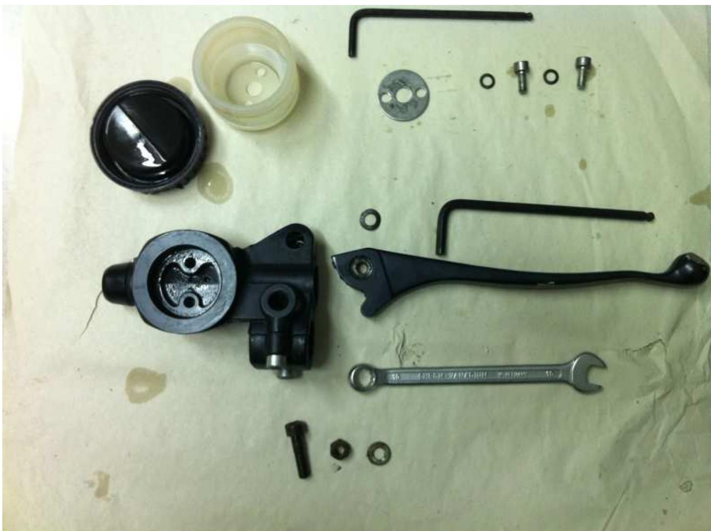
Als nächstes wird der Kolben entfernt. Hierfür fixierst Du den Hauptzylinder mittels eines alten Handtuchs (zur Vermeidung von Kratzern) im Schraubstock. Stelle sicher, dass die Seite nach oben zeigt, in der die Hohlschraube der Bremsleitung sitzt. Nicht zu feste anziehen, es ist Alu-Guss der leicht bricht!!
