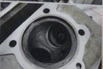
Aufwendig: Alukopf mit eingegossenen Brennraumklotzen aus Stahl
