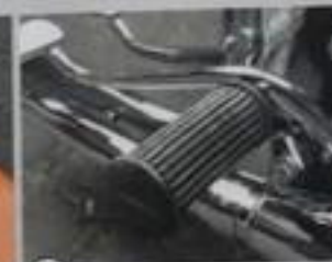
7 Abgelatschte Bremspedale und verschlissene Rastengummis deuten auf hohe Laufleistungen hin
