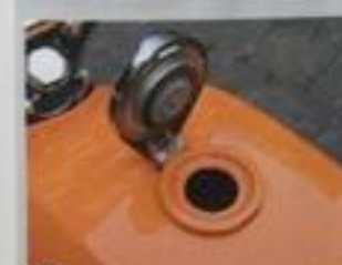
6 Schau rein: Lange Standzellen und moderner Kraftstoff sorgen für Korrosion im Tankinnern
