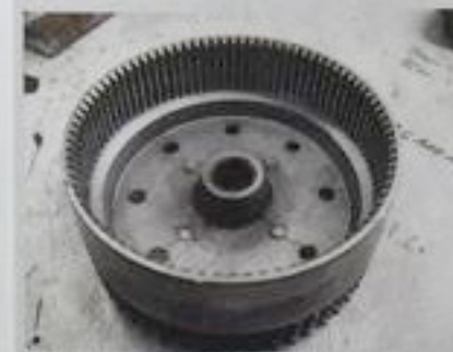
Qualitätsbeweis: Der kerbverzahnte stoffgeschützte Kupplungskorb aus Aluminium-Druckguss hält ewig
