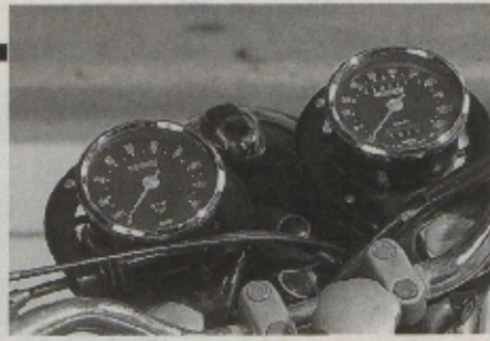
Britische Herrlichkeit: Smiths-Instrumente, leider nur an GT, S und frühen SF gebaut
