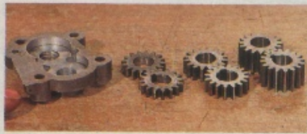
Schwachpunkt Ölpumpe: Besser sind SFC-Räder (Mitte) oder Spezialanfertigungen (rechts)
