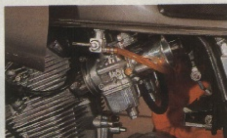
Muß sein: An eine sportliche Laverda gehören einfach Dell'Ortos mit offenen Ansaugtrichtern
