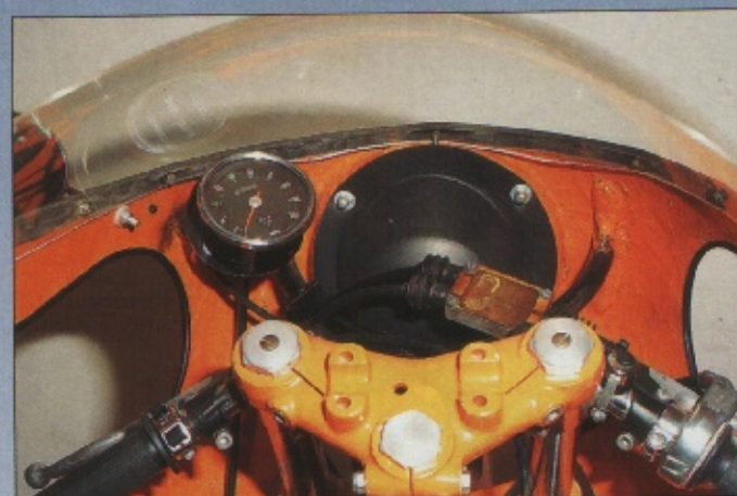
Das muß reichen: einsamer Smiths-Drehzahlmesser im Cockpit der Ur-SFC. Zündschloß und Ladekontrollleuchte kamen erst später hinzu
