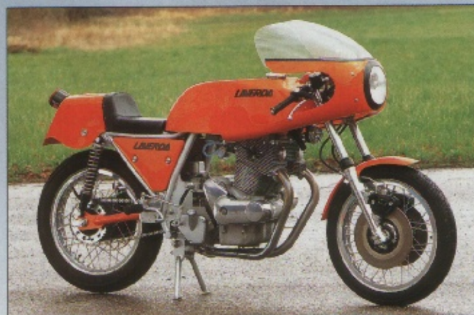
Moderne Zeiten: Mit drei Scheibenbremsen heizte die SFC der zweiten Serie der Konkurrenz ein. Dank geändertem Hauptständer konnte jetzt...
