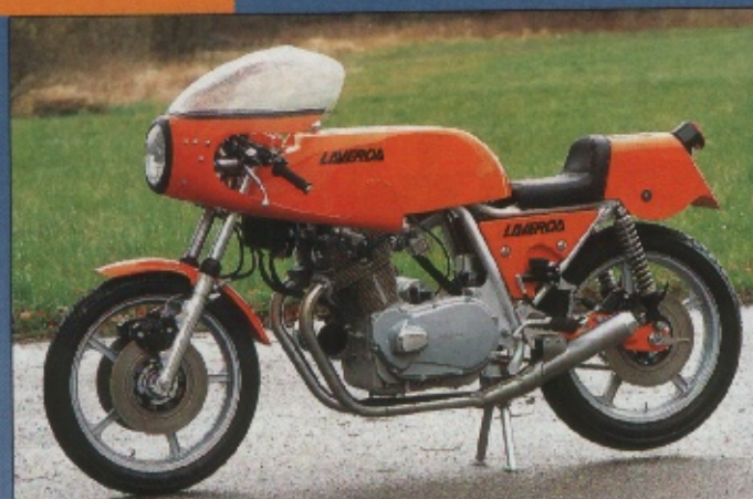
„Electronica“ steht für die elektronische Bosch-Zündung – auf den ersten Blick erkennbar am neuen Magnesiumgehäuse des Primäranschlusses
