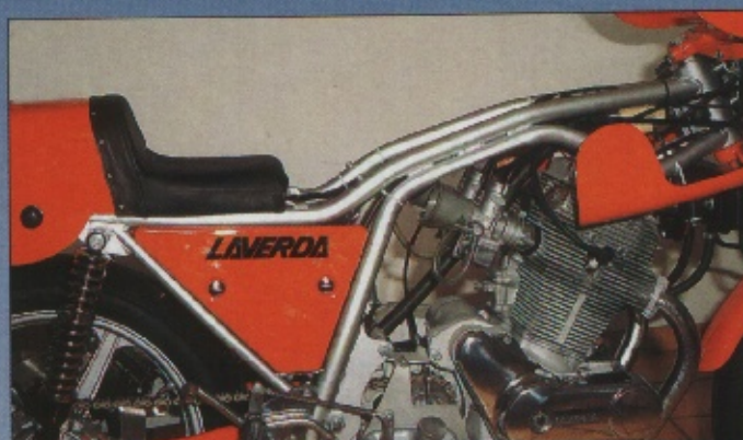
Ab 1974 diente in der SFC kein verstärkter SF-Rahmen mehr, sondern ein eigenes Rohrgeflecht. Das Heck ist deutlich tiefer angebracht
