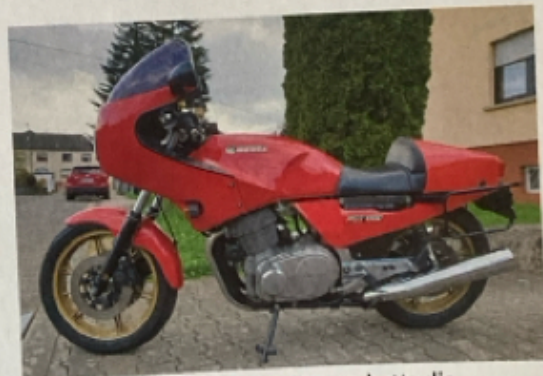
Im Gegensatz zu ihren Vorgängern hatte die 1000 RGS einen Hubzapfenversatz von 120 Grad
