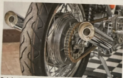
Bei der Zwei-in-zwei-Auspuffanlage der SFC-Replika lassen sich die Dämpfer entfernen
