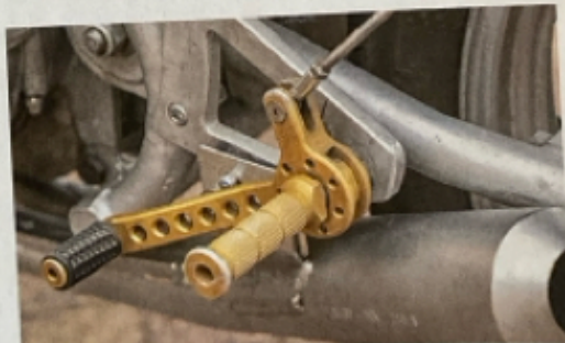
Auch beim linksseitigen Fußbremshebel wurde auf minimales Gewicht geachtet
