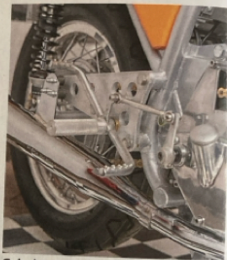
Gelochte Rastenanlage: spart Gewicht und ist an Hardys Maße angepasst
