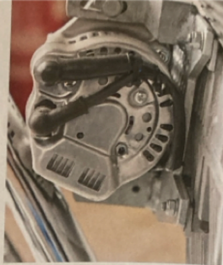
Elektrik-Power: verstärkter Generator mit Riemenantrieb
