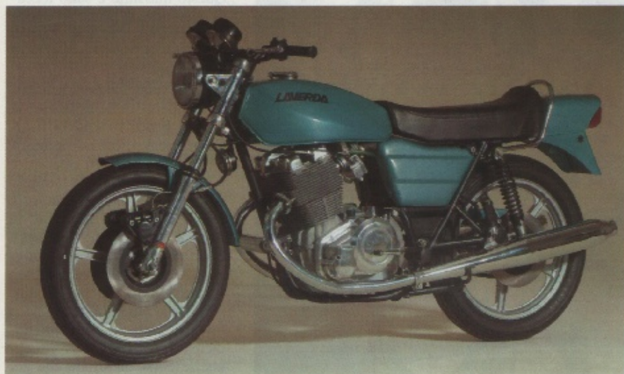
Nella foto qui sopra, la «500» bicilindrica bialbero realizzata senza molto successo nel 1977. In alto, la poderosa «1000» a 3 cilindri bialbero del 1983. Qui sotto la veloce «750 SFC» del '71.
