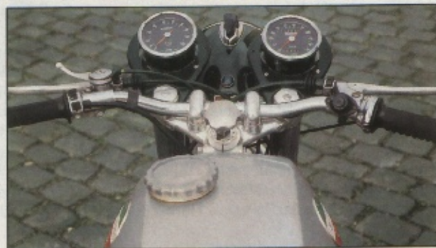
750 S, Modell 1971, mit neuen Bremsen, Interferenzrohr vorn und Smiths-Instrumenten
