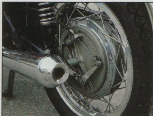
Das 1973er Modell 750 SF1 wartete mit gestängebetätigten Duplexbremsen und neuen Schalldämpfern auf. Die Anzeige-Instrumente kamen aus Japan
