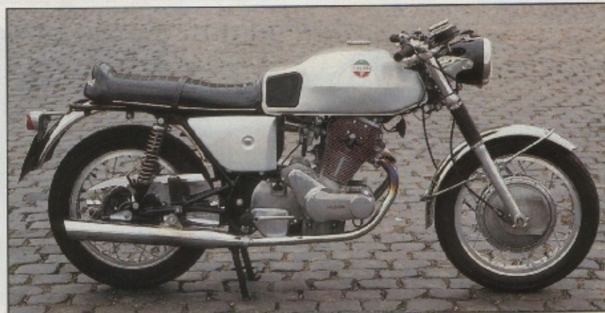
750 S, Modell 1971, mit neuen Bremsen, Interferenzrohr vorn und Smiths-Instrumenten
