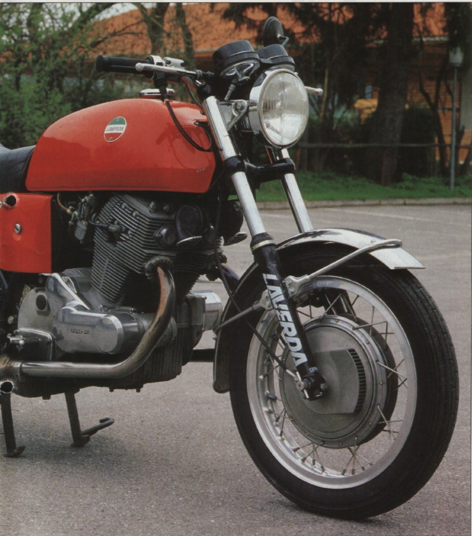
Bei der 750 SF1 rückte das Interferenzrohr der Auspuffanlage unter das Getriebe und setzte in Kurven schnell auf
