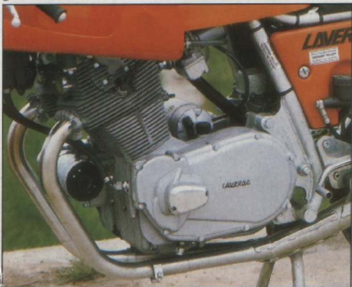
Konsequent: An der endgültigen SFC bestanden beide Gehäusedeckel aus Magnesium und unterschieden sich in der Form
