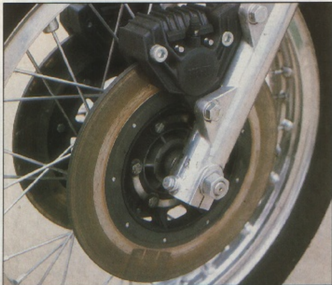
Bessere Wirkung: Doppelscheiben-Bremsanlagen für die SFC gab es ab 1974
