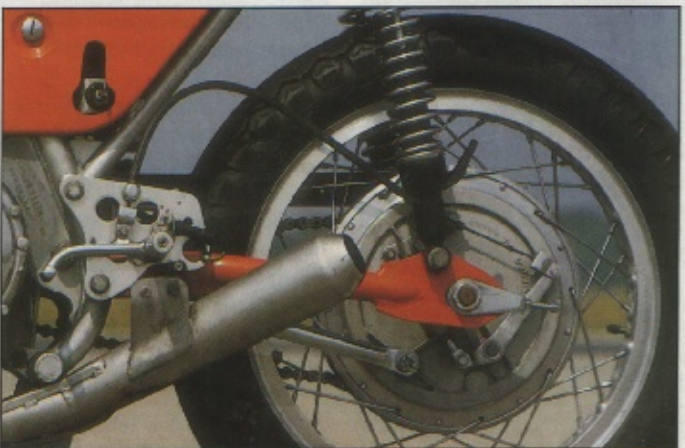
Handarbeit: Renn-Megaphon an einer der ersten SFC, kenntlich an Trommelbremse und Seitendeckel
