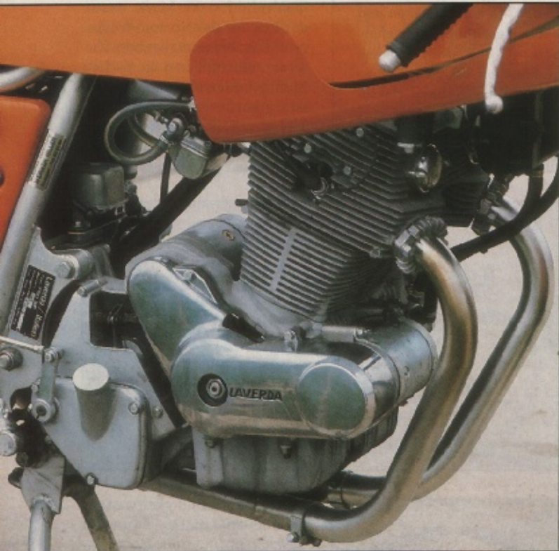
Honda läßt grüßen: Der SFC-Paralleltwin ähnelt frappierend dem der Honda CB 72
