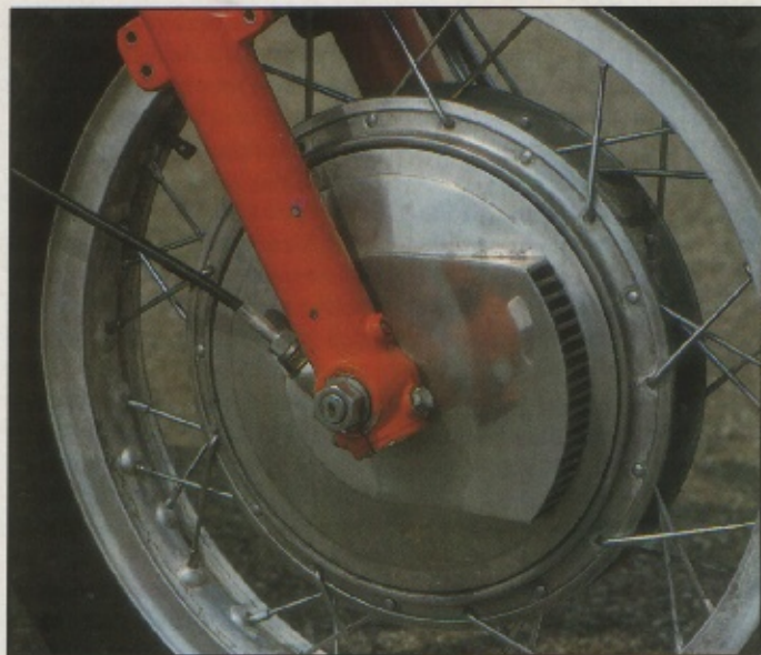
Frühes Modell: Die ersten 164 Maschinen waren mit Laverda-Trommelbremsen ausgerüstet
