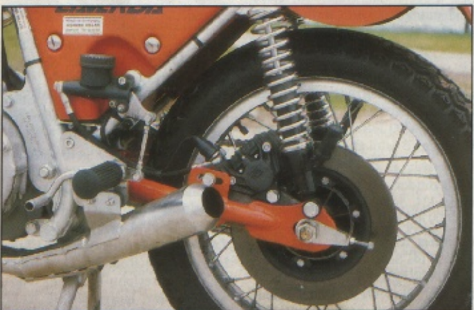
Deutlich: Das Megaphon wurde im Handgepäck mitgeliefert, mit den Scheibenbremsen kamen neue Seitendeckel
