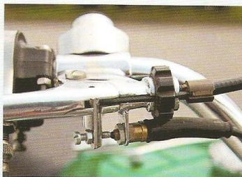
Diese wilde Konstruktion betätigte das Bremslicht, wenn vorn gebremst wurde
