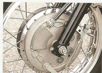
Die Trommelbremsen (vorn 230 mm groß) baute Laverda ab 1970 selbst
