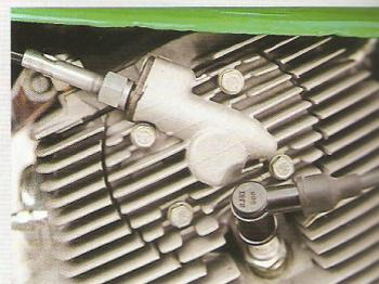
Die Welle für den Drehzahlmesser befindet sich auf dem Zylinderkopf
