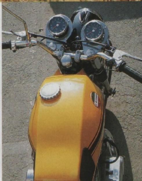
**Breganzer Wuchtrumme:** Die typischen Merkmale der 69er-750 S waren Buckeltank mit Schraubverschluss, Smiths-Einzelinstrumente sowie die üppige Grimeca-Bremse
