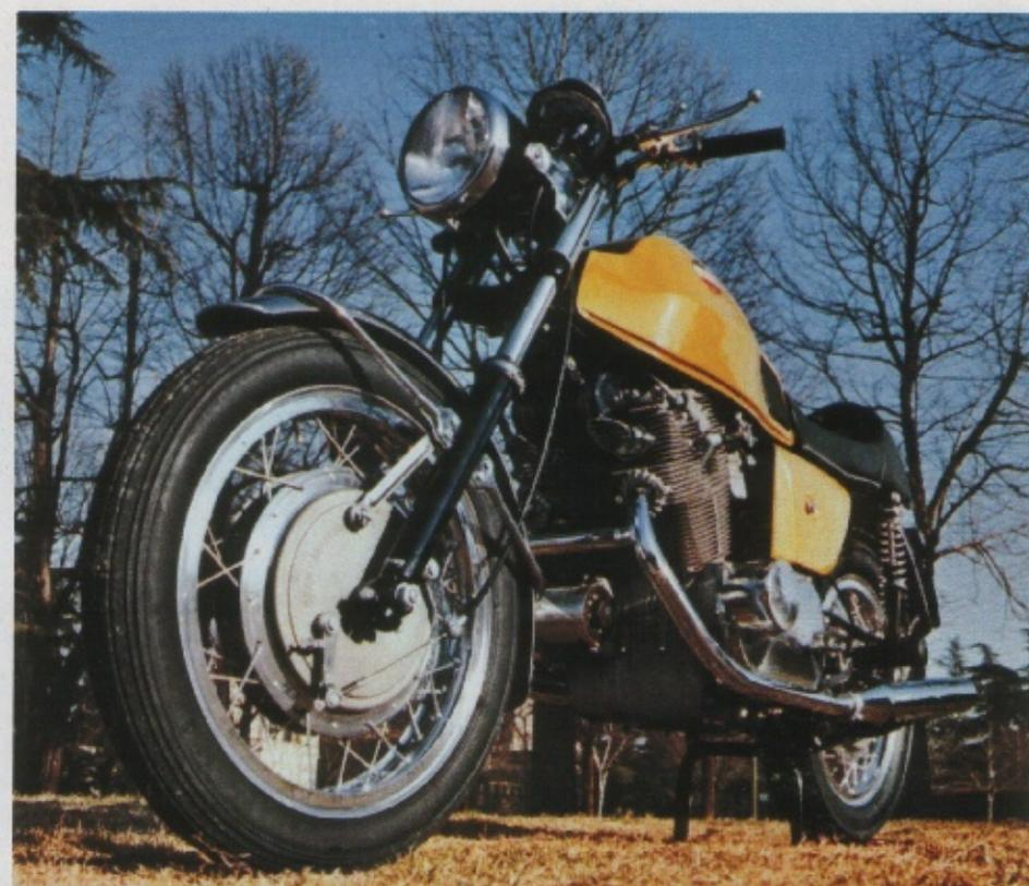
▲ Nicht besser, aber kostengünstiger: Ab Modelljahr 1970 erhielt die 750 S eine neue, selbstzentrierende Vorderradbremse, der Motor wurde leicht gesenkt, die Kupplung modifiziert
