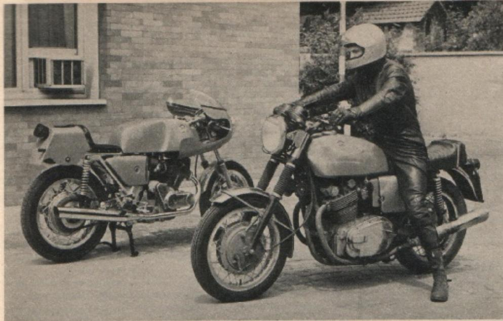
Das Gewicht der Maschine konnte um 10 kg auf nunmehr 210 kg abgesenkt werden. Besonderes Augenmerk wurde darauf verwandt, den production-racer in allen Details so auszubilden, daß er nicht nur durch seine Spitzen-
