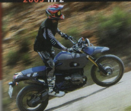
Gelobt sei, was hart macht: Mit Gitterrohrrahmen und Luftfederbein stemmt die BMW HP2 nur knapp 200 kg auf die Waage
