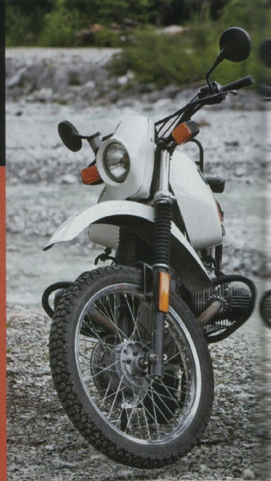
Ab 1987: Doppelgelenkschwinge gegen Kardanreaktionen, Bremse mit Seilzug
