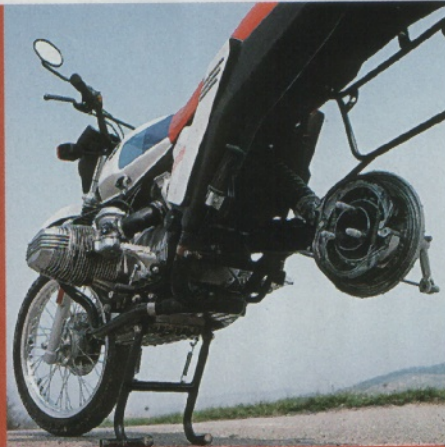
Eins, zwei, drei, raus: einfacher Hinteradausbau dank der Einarmschwinge
