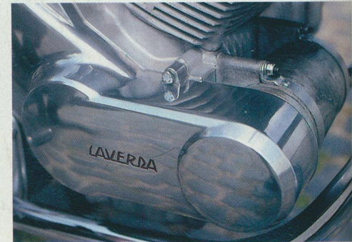
Die Lichtmaschine sitzt platzsparend vor den Zylindern. Antrieb per Keilriemen
