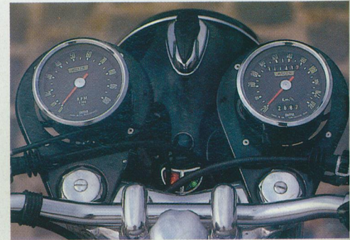
Die Smiths-Instrumente sind zum Schutz gegen Vibrationen in Gummi aufgehängt
