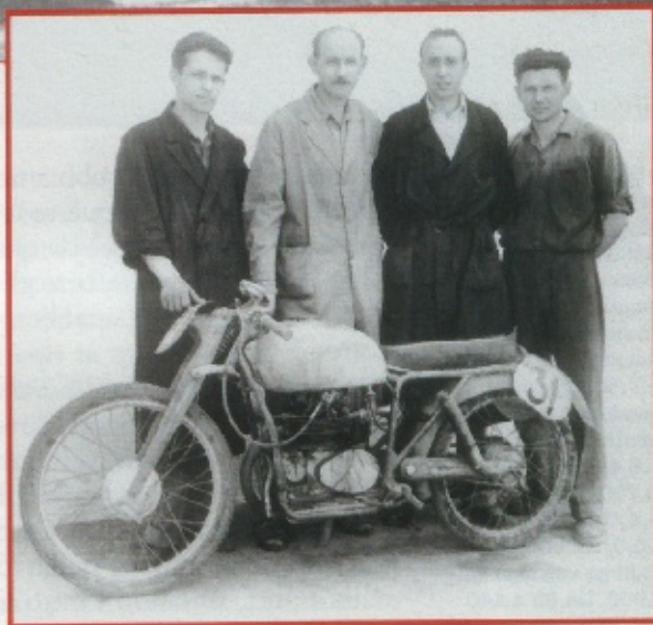
•Sopra, il prototipo della Ceccato 75 monoalbero con la distribuzione comandata a catena secondo la modifica di Guido Menti e Pietro Ceccato al progetto originale di Tagliani. Anche la catena però non soddisfa e la versione definitiva avrà così gli ingranaggi. I personaggi nella foto sono da sinistra Olinto Fongaro capo Squadra corse, Gino Concato detto "Mostaccio" caporeparto attrezzeria, Guido Menti progettista e Severino Frigo del Reparto corse.
