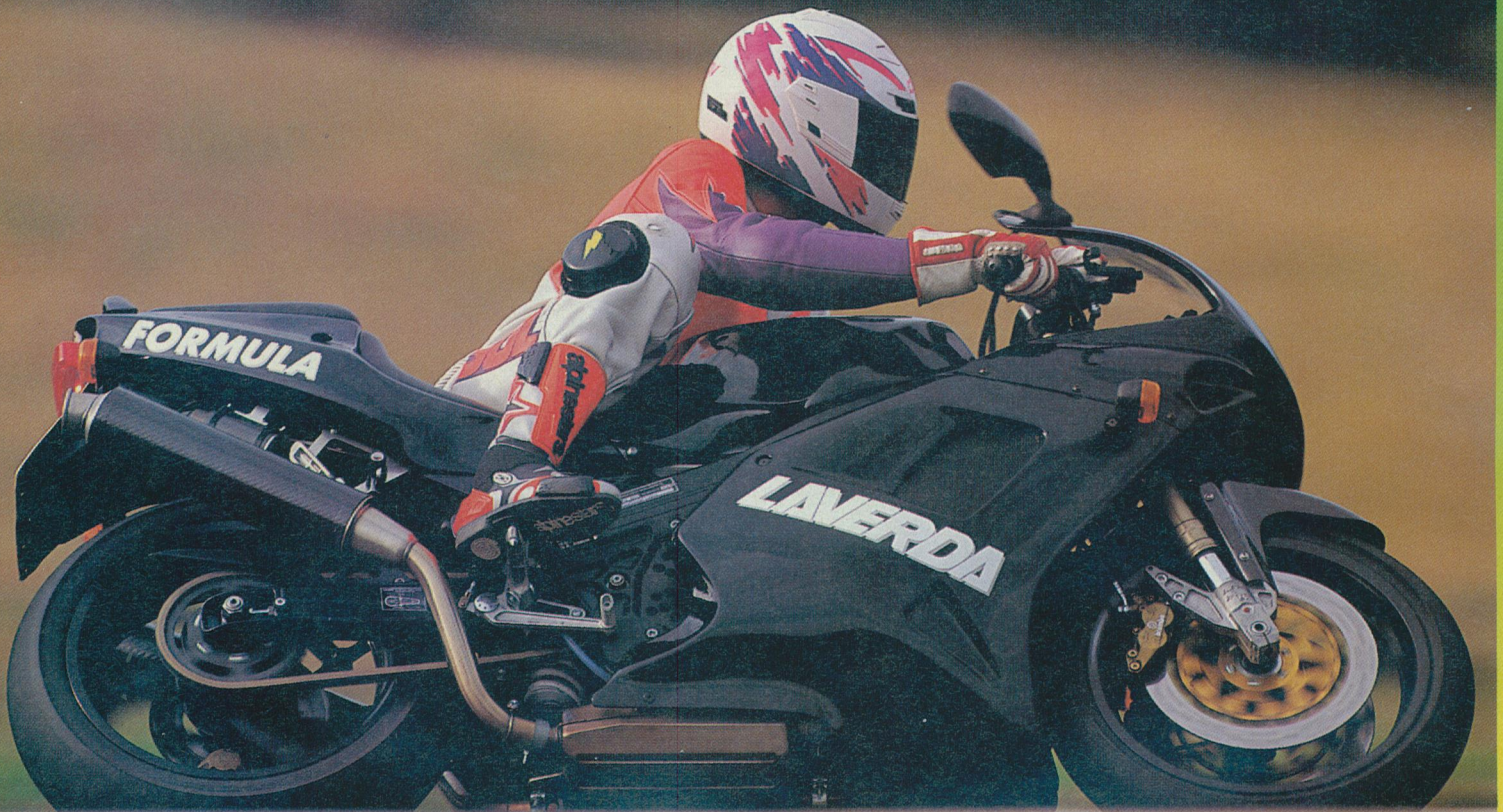
Die Laverda bietet feinste Verarbeitung und edle Teile: Federelemente von White Power, Gußscheiben von Brembo und einen Alutank unter der Sitzbank
