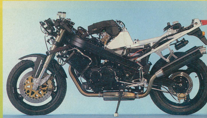
Die Laverda bietet feinste Verarbeitung und edle Teile: Federelemente von White Power, Gußscheiben von Brembo und einen Alutank unter der Sitzbank
