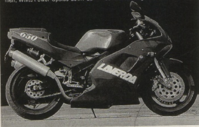
Auf dem Prüfstand überstand der gegenläufige, luft-/ölgelühlte Twin kluglos 130 Stunden Dauervollgas
