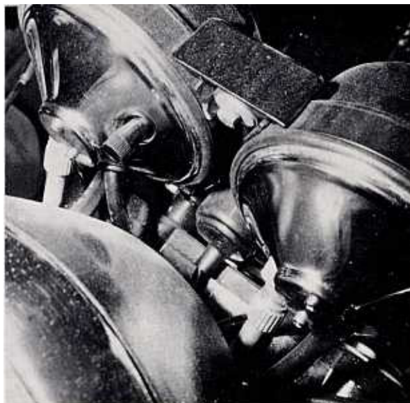
Bild 226 Die neueste Instrumentenbefestigung von unten. Die Sechskantschraube in der Mitte hält den Rahmen mit Gummipuffer fest
