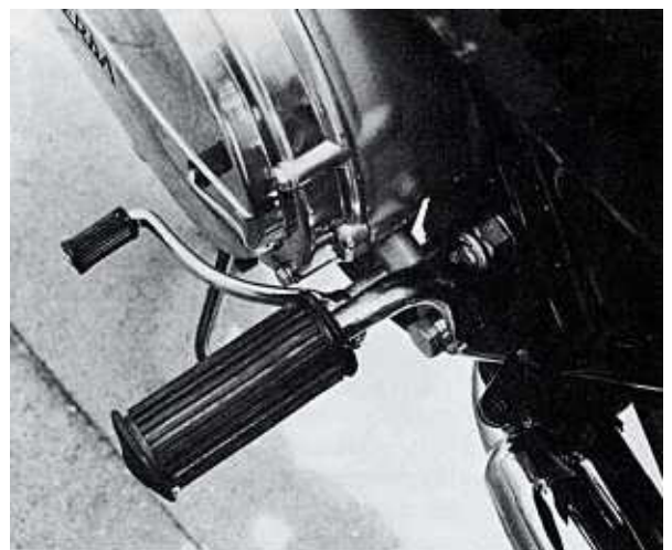
Bild 147 Eine Jarama mit Schaltung links. Die Übertragung nach rechts arbeitet recht gut. Am Kurbelgehäuse das Lager für den Schalthebel
