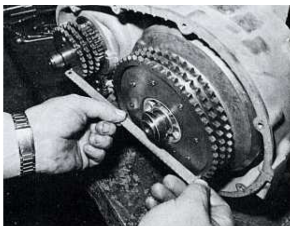
Bild 123 Nach dem Einbau der Kupplung, aber vor dem Auflegen der Primärkette wird geprüft, ob beide Kettenräder fluchten. Die Einstellscheiben auf der Kupplungswelle nicht vergessen
