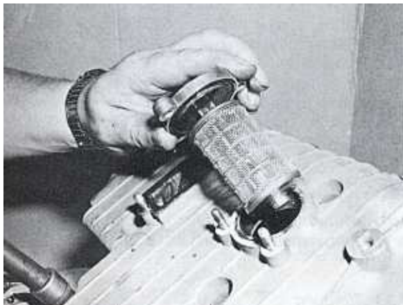
Bild 41 Der Ölfilter einer Dreizylinder (der Motor ist ausgebaut). Der Ölfilter der Zweizylinder ist ähnlich, wenn auch etwas grösser, und dient auch als Ablassstopfen
