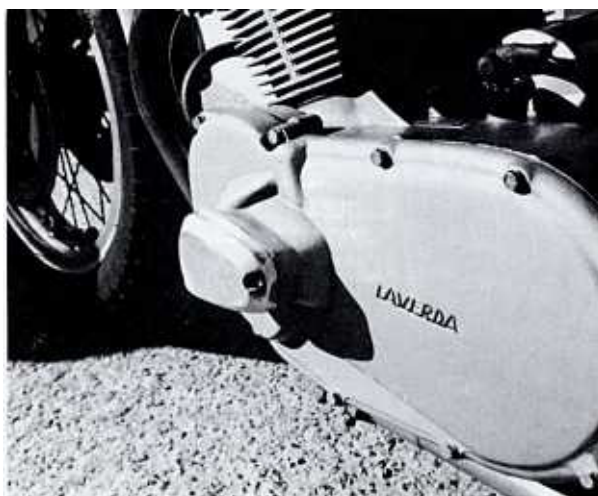
Bild 221 Das angebaute Kästchen aus Magnesiumlegierung für den Impuls-geber am Primärtriebsdeckel einer SFC
