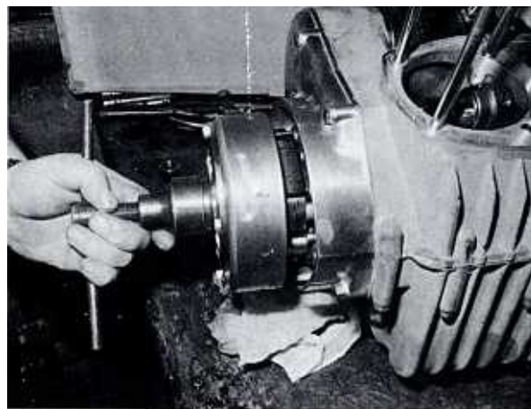
Bild 197 Abziehen des Schwungrades/Lichtmaschinenrotor mit Spezialabzieher
