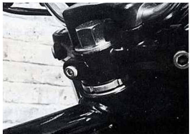
Bild 44 Zum Drehen gewisser Lenkkopflager-Einstellmuttern benötigt man spezielle Hakenschlüssel, mit denen sich die Mutter besonders leicht drehen lässt
