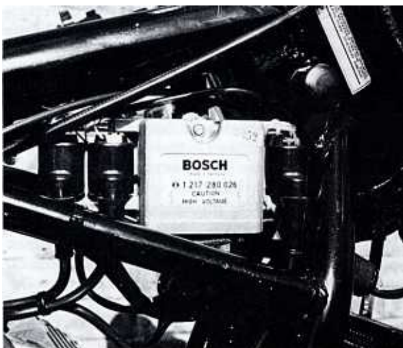
Bild 205 Die sehr zuverlässige Bosch-Elektronik des HKZ-Zündung, hier an einer Jarama
