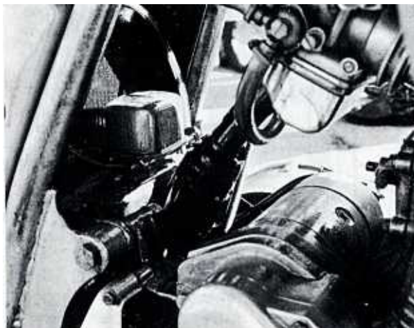
Bild 194 An der SFC sitzt der Lichtmaschinenregler vor der Batterie
