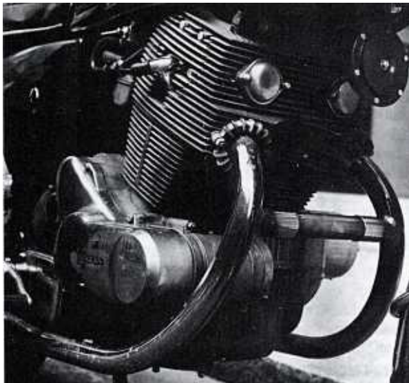
Bild 175 Die Auspuffanlage eines älteren Zweizylinders, hier mit zusammen-gestecktem Ausgleichsrohr
