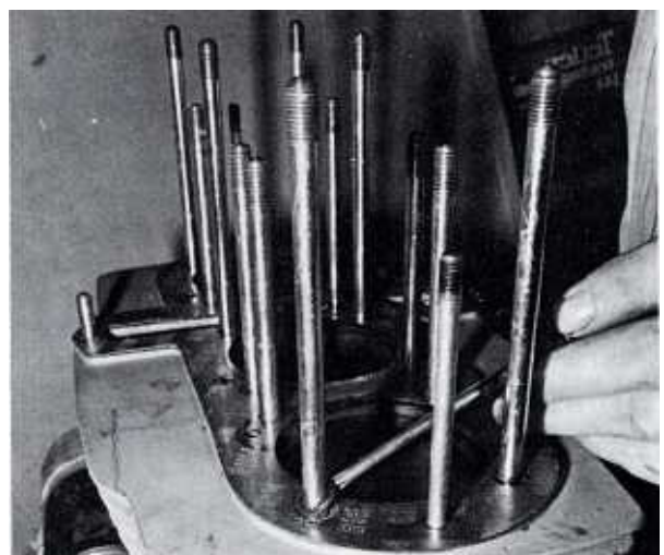
Bild 97 Der Schraubendreher zeigt auf den kleinen O-Ring über der Stiftschraube mit der Zylinderkopfdichtung darunter
