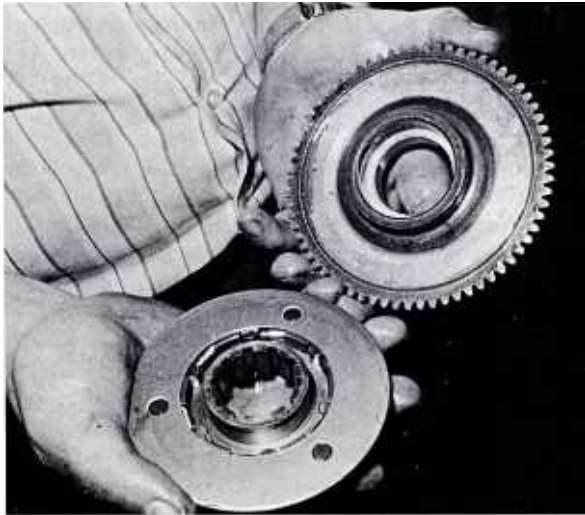
Bild 209 Der Anlasserfreilauf eines Dreizylinders mit eingesetzten Federn und Rollen. Am Zweizylinder sieht der Freilauf gleich aus
