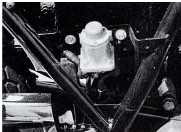
Bild 203 Das Anlasserrelais eines 72er Zweizylinders. Bei späteren Ausführungen sass das Relais nicht mehr unter der Seitenverkleidung, die Batterie war nicht mehr längs eingebaut und das Luftfilter fehlte
