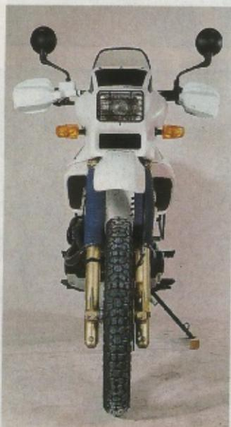
**Der Zweizylinder-Motor der Atlas wurde aus dem 500er Straßemotor entwickelt. Die insgesamt acht Ventile werden über zwei obenliegende Nockenwellen und Tassenstößel betätigt. Ungewöhnlich: Der Ölkühler ist unter dem Scheinwerfer platziert. Das handliche und sehr stabile Fahrwerk verschafft der Laverda eine Spitzenstellung unter den Touren-Enduros.**
