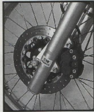
**Während die Schalter hervorragend sind, bieten die winzigen Instrumente ein eher klägliches Bild. Die Vierkolben-Scheibenbremse packt kraftvoll und gut dosierbar zu. Gepäckprobleme löst die Firma Becker mit einem speziell angepassten Kofferhalter, der über die Laverdahändler erhältlich ist.**
