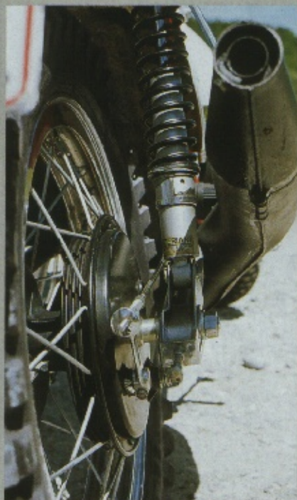
Die hinteren, nur in der Vorspannung verstellbaren Federbeine lieferte Ceriani, das Endstück des Auspufftopfes war zum Reinigen abschraubbar
