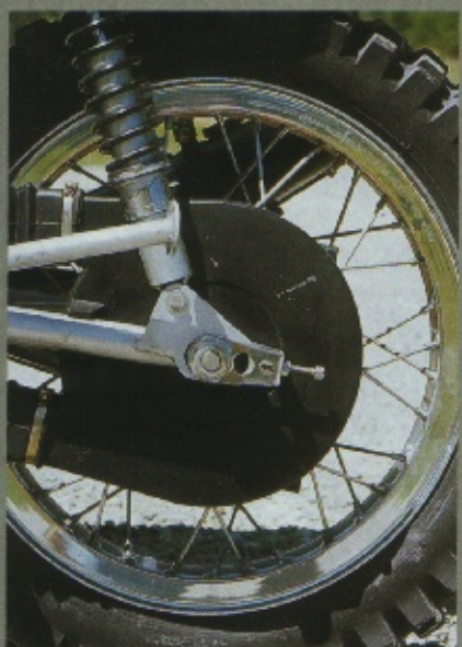
Gegen Dreck und Verschleiß: sauber verarbeiteter, dichter Kettenkasten, frei nach MZ oder Simson
