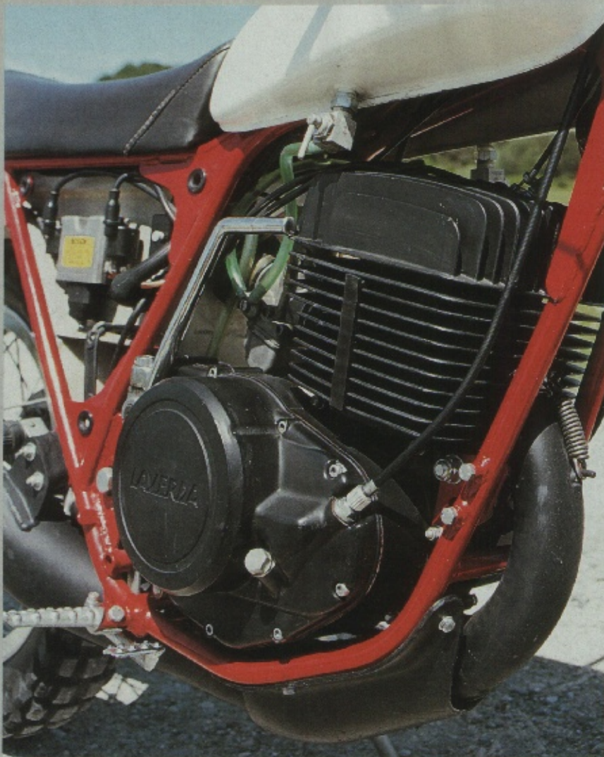
Unter dem Laverda-Deckel sitzt die Trockenkupplung, davor der geradzahnte Primärtrieb. Beachtenswert: die elektronische Doppelzündung von Bosch, übersichtlich eingebaut. Ungewöhnlich: Schutzabdeckung über dem Krümmer
