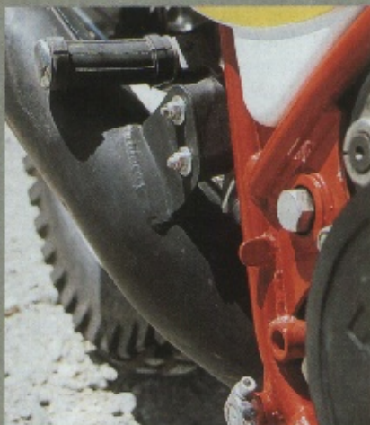
Zum Schutz vor Vibrationsrissen wurde der Auspufftopf mit dicken Gummiblöcken am Rahmen befestigt
