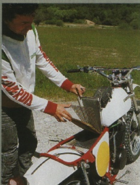
Ebenso dicht wie der Kettenkasten: leicht zu reinigender, großer Staubluftfilter unter der gesteckten Sitzbank
