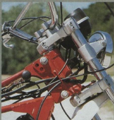
Unter dem 11-Liter-Tank befindet sich der stabile Lenkkopf. Zum Verstellen obere Schraube lösen und anderes Loch wählen
