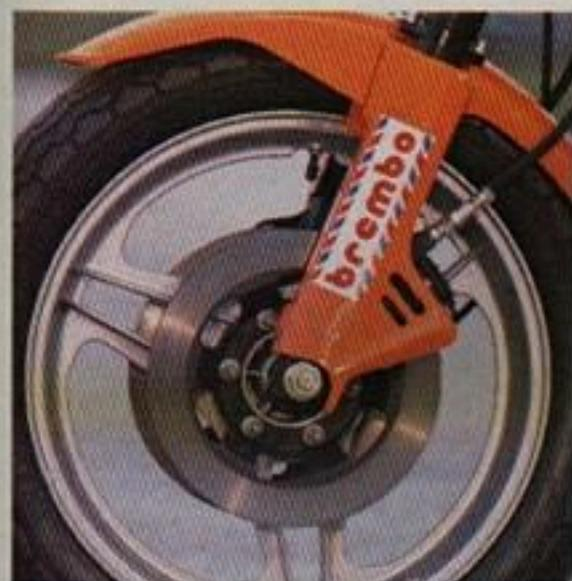
In questa «Trofeo» per giovanissimi la frenata è assicurata da due freni a disco Brembo anteriori da 260 mm e da un tamburo monocamma posteriore di 160 mm. Notare, qui sopra, la carenatura dei foderi della forcella. Il motore è «tutto Laverda» ed eroga una potenza di 25 CV. Il telaio è a diamante in tubi quadri con monoammortizzatore posteriore
