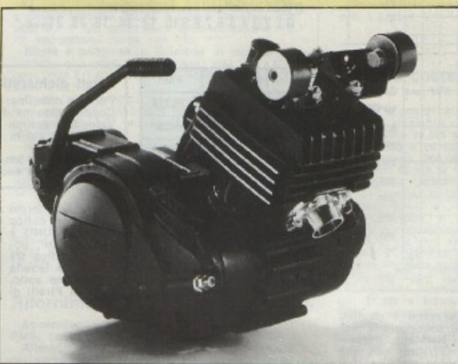
Il nuovo propulsore totalmente « made by Laverda » nonostante la presenza del circuito di raffreddamento a liquido ha il cilindro dotato di alettatura con funzioni di raffreddamento e di estetica. I due tamponi di gomma ben visibili sulla testa si interpongono fra la testa stessa e le stette saldate ai tubi inclinati del telaiio per eliminare le vibrazioni. Tolti il coperchietto sinistro del carter appare il meccanismo del miscelatore che elabora una miscela al 2%.
