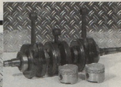
Wellensalat: oben die Kurbelwelle mit 180-Grad-Kröpfung, davor ein Standard- und ein höher verdichtender Kolben; unten die für ihre feinen Vibrationen berüchtigte 120-Grad-Welle. Das Gehäuse läßt sich horizontal teilen
