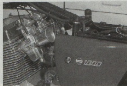
Achtung: Bei offenen Trichtern muß der Seitendeckel mit einer Schraube gesichert werden
