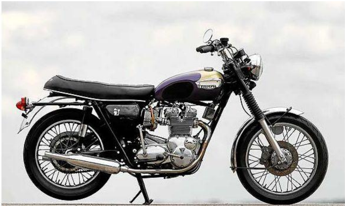
Mitte 1972 führte Triumph bei der Trident ein Fünfganggetriebe ein, Ende 1972 erhielt sie eine Scheibenbremse im Vorderrad und nannte sich T 150 V.
