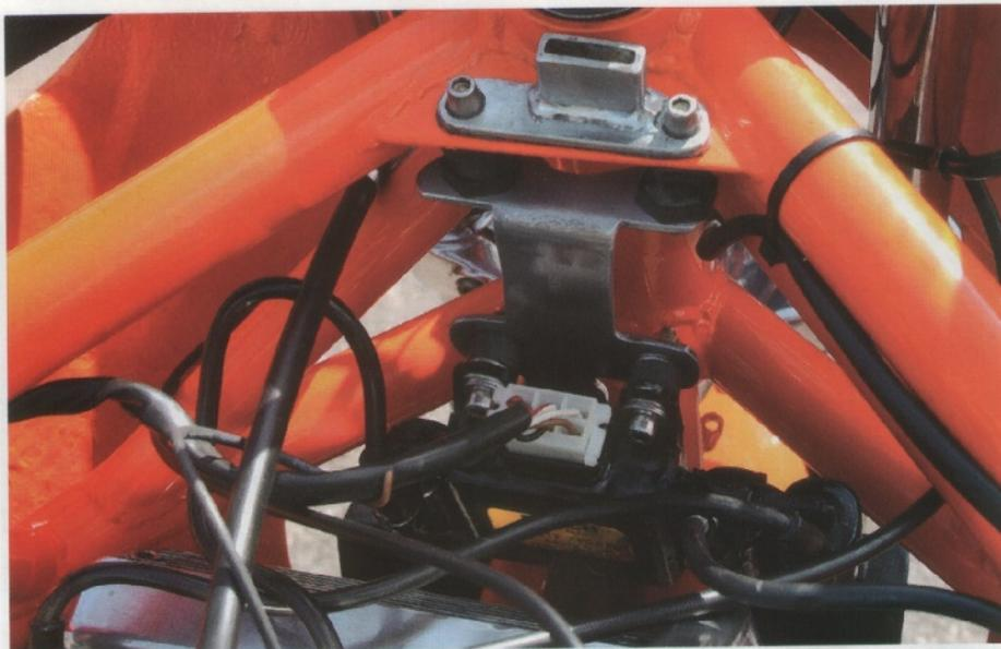
*Sopra, all'interno del traliccio in tubi al cromo-molibdeno è alloggiato l'impianto elettrico del tutto ricostruito.*
