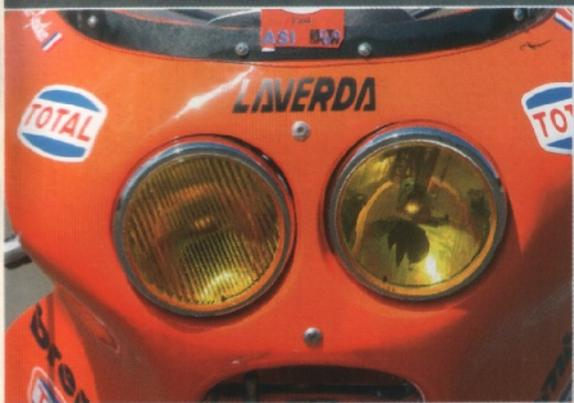
La foggia della carenatura a due fari e la caratteristica bombatura del cupolino in plexiglass ricordano moltissimo quelle della prima versione della Laverda sei cilindri, anch'esse realizzate dai fratelli Stanga. Una volta in carena, il pilota è completamente riparato dal carico aerodinamico anche a 250 chilometri orari.
