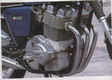
dopo aver sperimentato e scartato quello a cinghia dentata soprattutto per la necessità di una sua sistemazione in ambiente lontano dall'olio (e quindi sull'esterno del blocco) con un impatto estetico discutibile. In effetti, sui primi prototipi il comando distribuzione era già all'esterno sul lato destro del motore ma, essendo sempre a catena, era inserito all'interno dell'alettatura di cilindro e testa e quindi ben "mimetizzato".
