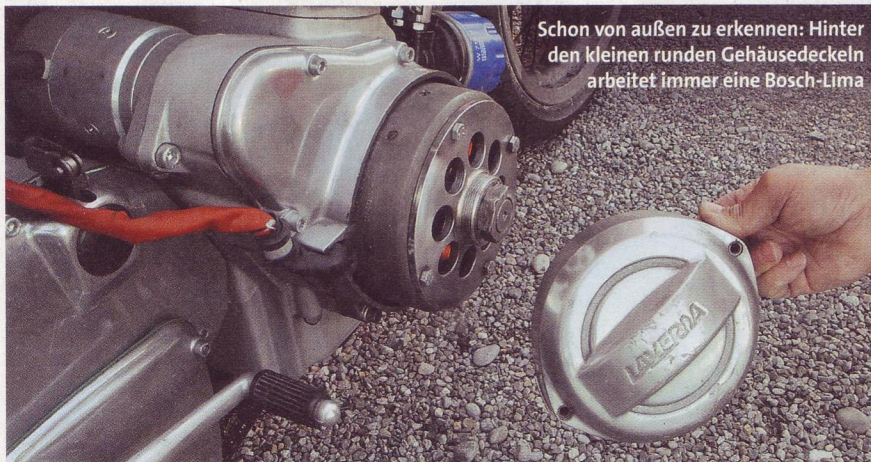
Geringe Leistung: Die Ladespule der Bosch-Lichtmaschine leistet nur zwischen 100 und 150 Watt
