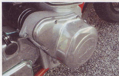
Der Seitendeckel der Nippon-Denso-Lima ist abgedichtet, da sie „im Ölbad“ arbeitet
