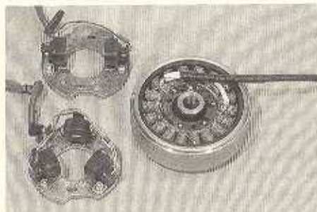
Keine Probleme: die Nippon-Denso-Lima. Unten links die drei Pickups für den 120-Grad-Motor
