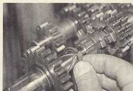
Bevor wir das Schafttrad auf die Hauptwelle schieben, muß der Druckring aufgesetzt werden
