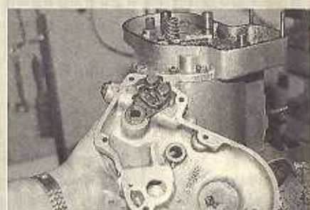
Fast fertig: Der Deckel mit Schaltklinken und Schaltwelle wird aufgesetzt
