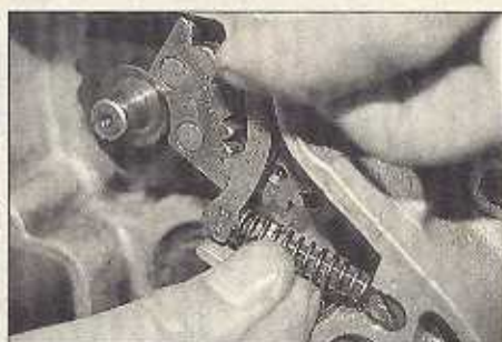
Etwas pfriemelig, aber kein Problem: Das Einsetzen der Gangarretierung mitsamt Druckfeder
