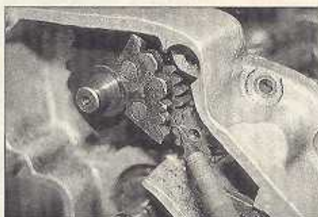
Das Zahnsegment des Fußschaltautomaten wird mit reichlich Fett eingesetzt
