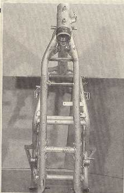
Kein Unfallschaden: Der Rahmen ist so krumm, um dem linken Krümmer Platz zu schaffen
