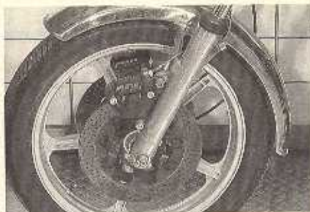
Das hält: Doppelscheibe von Brembo. Nur die ersten 200 Maschinen hatten vorn eine Trommel
